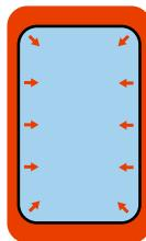
Традиционные системы нагревания воды обеспечивают медленную передачу тепла. Теплоноситель теплового насоса располагается вокруг водонагревателя. Нагревания воды по такой технологии занимает в два раза больше времени, чем при использовании TWS технологии.
