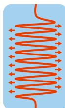
TWS технология предусматривает прохождения теплоносителя теплового насоса через спираль установленную внутри бака. Вода в баке разделяется на слои, при этом часть воды достигает нужной температуры быстрее. TWS технология дает более эффективную передачу тепла и более высокую температуру воды.
