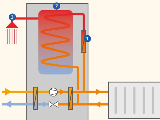
1 Небольшая часть теплоносителя, возвращающегося из системы отопления, проходит через пароохладитель.
